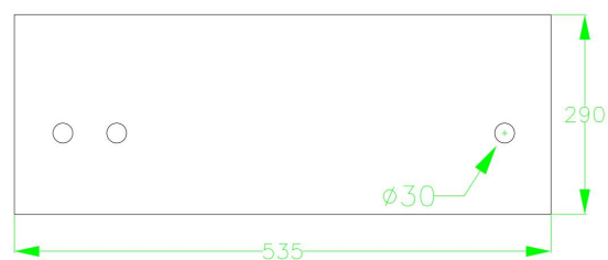
柜顶过线孔（敲落孔）
