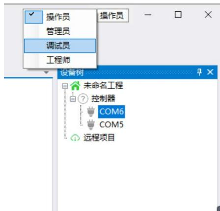
登录调试员后。点击设备树，选中对应现场接线的 COM 口，(设备出厂时已添加了两个 COM 口)；单击右键，选择“初始化设备”（如下图一）；将弹出“自动收集设备”选项框（如下图二）；首次初始化选择“清空并重新搜索设备”命令项，(如下图二) ;然后点击“开始”。
