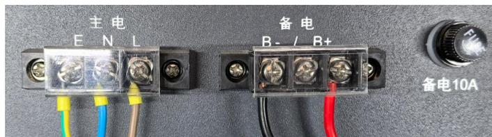
E、N、L 分别为主电 AC220V 地线、零线、火线的接线端子，最大接入电流容量为 3A；B-、B+为备电接线端子，出厂时已将备电引出至机柜底部电池仓处（红色接正极，黑色接负极），见下图。
