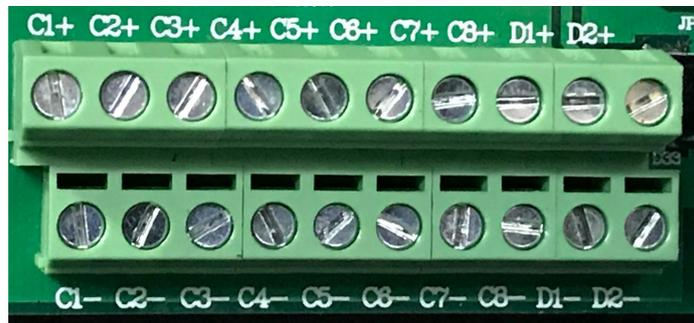
D1+、D1-为火灾显示盘的接线端子（预留），输出电流容量为 1mA；
