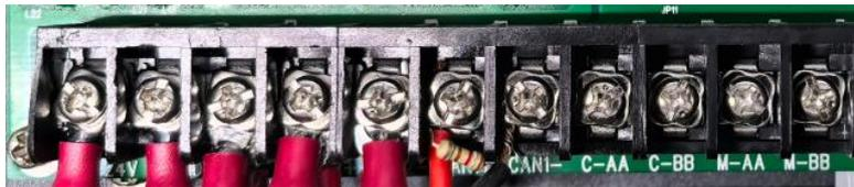
CAN1+、CAN1-为集中机和区域机的 CAN 通讯接线端子，最大输出电流容量为 1mA；
